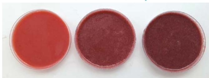
De izquierda a derecha, sin zumaque, con 2% de zumaque y con 4% de zumaque
